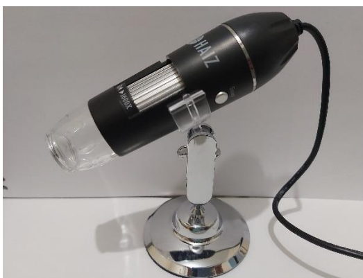
Figura 5: Dispositivo de ampliação de imagem (Microscópio USB)
