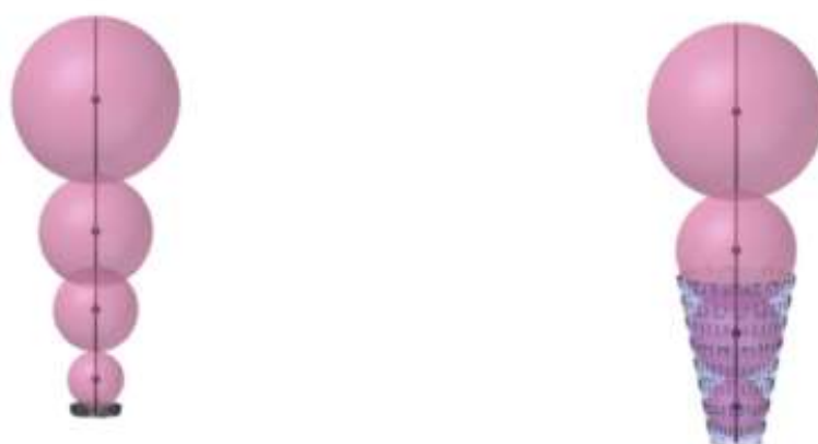
Figura 31 – Formação de um tronco de cone como envoltória de uma família de esferas cujos centros percorrem um segmento de reta, com variação do raio ao longo da trajetória.
