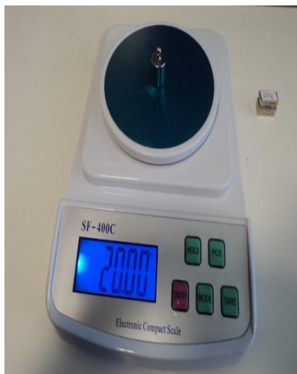
Figura 6 Balança digital com peso de 20 g
