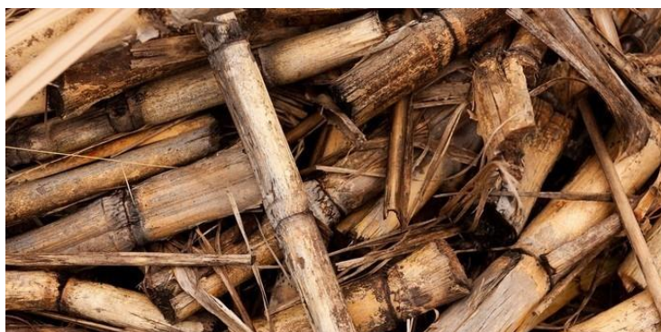
Figura 20 - O bagaço da cana é aproveitado para a produção de energia.
