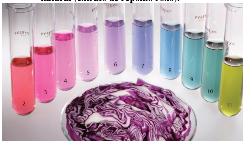
Figura 12 - Representação de soluções básicas ou ácidas com indicador de origem natural (extrato de repolho roxo).
