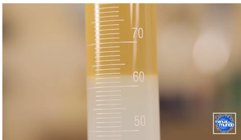
Figura 9 - Experimento sobre teor alcoólico da gasolina
