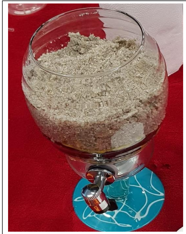
Foto 4 – Filtro adaptado com carvão ativado e areia.
