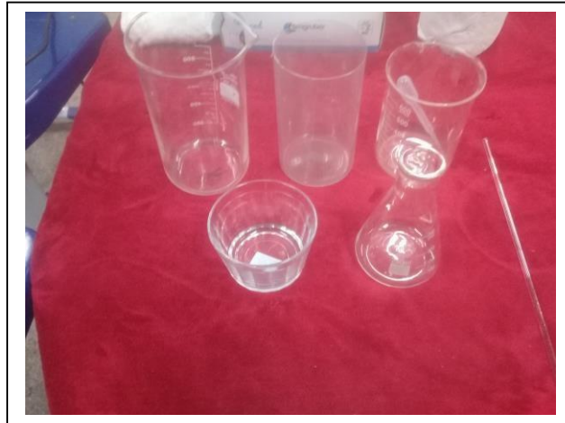
Foto 2 – Bechers, Erlenmeyer, Copo de vidro, Bastão de vidro, Pipeta de Pauster e Frascos.
