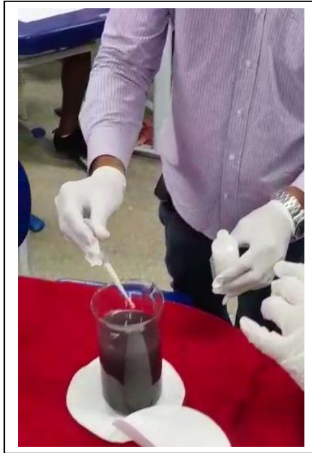
Foto 16 – Correção de pH com Hidróxido de Cálcio.
